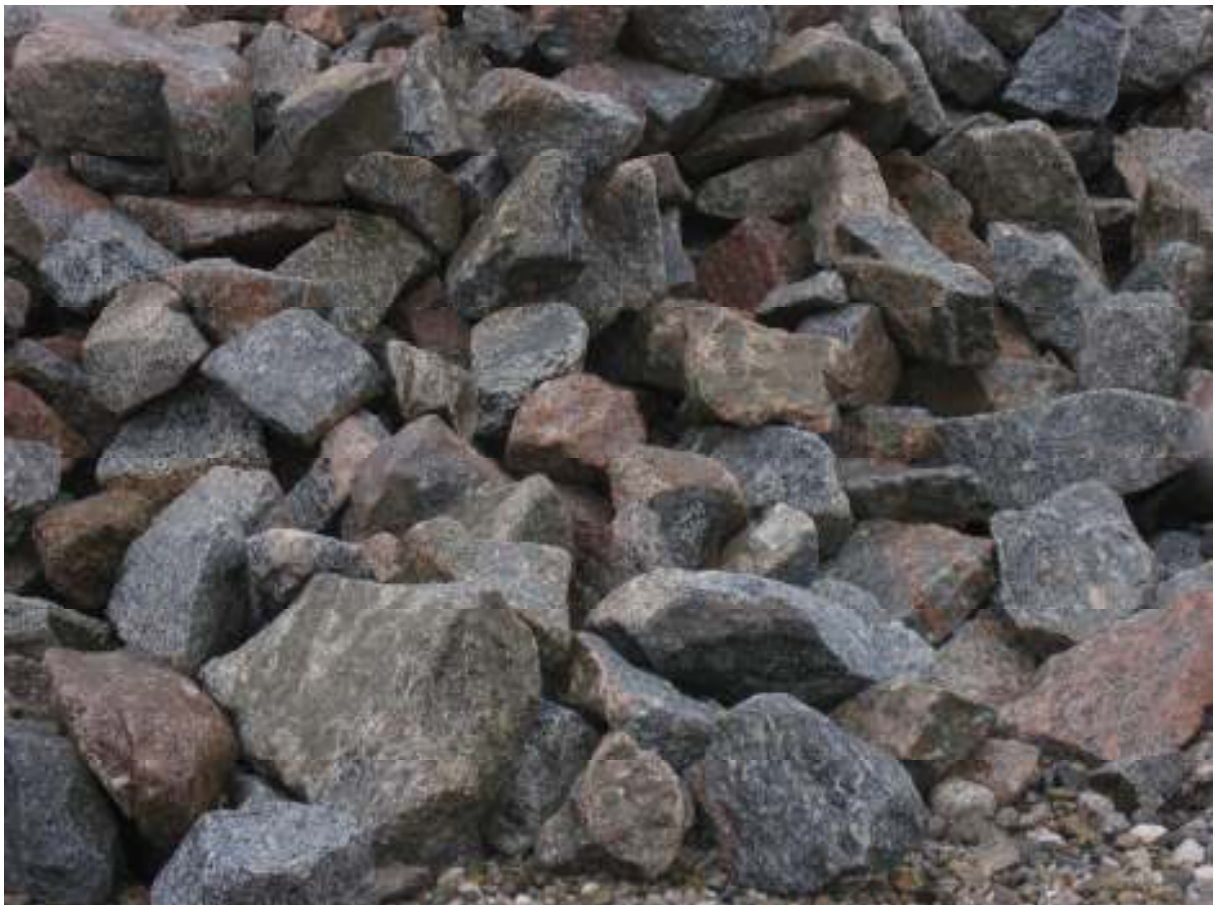
Granit Wasserbausteine in verschiedenen Größen
